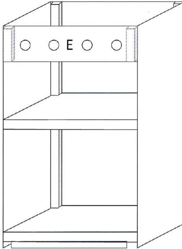
Couper un rectangle de 42 cm par 30 cm. (G) Découper une ouverture à l'aide de la scie sauteuse pour la porte vitrée du four. (l'astuce de Bob : percer des trous pour pouvoir passer la scie et amorcer la découpe.) Visser les charnières et l'aimant comme pour une porte de placard. Découper le plexiglas avec une scie à métaux en laissant une bonne marge (c'est un matériau très fragile, attention !) puis le visser derrière l'ouverture.
